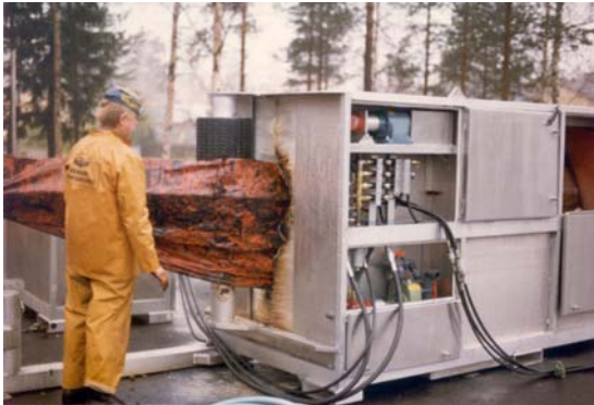
Roto-PAC kelaan liitetty puhdistuslaitteisto poistaa tehokkaasti ja turvallisesti öljyt ja kemikaalit öljypuomista.
